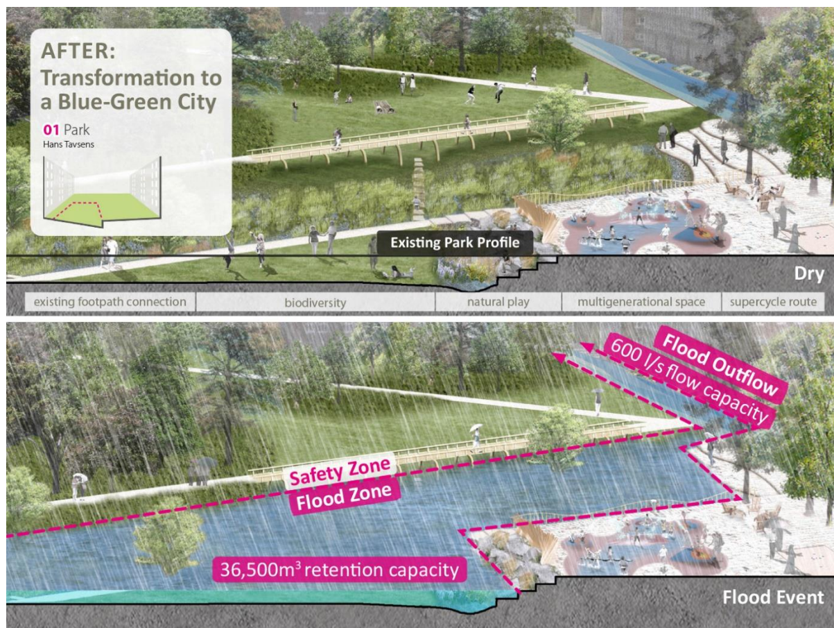
64. ábra: 4P Bicskei Zöld Fal pillér előképe: Park záportároló és rekreációs funkciókkal „szárazon” és vízzel feltöltött állapotban (forrás: Copenhagen Cloudburst Masterplan, Ramboll Studio Dreiseitl)
